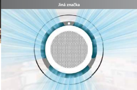
3-cestné proudění vzduchu se slepým bodem.
